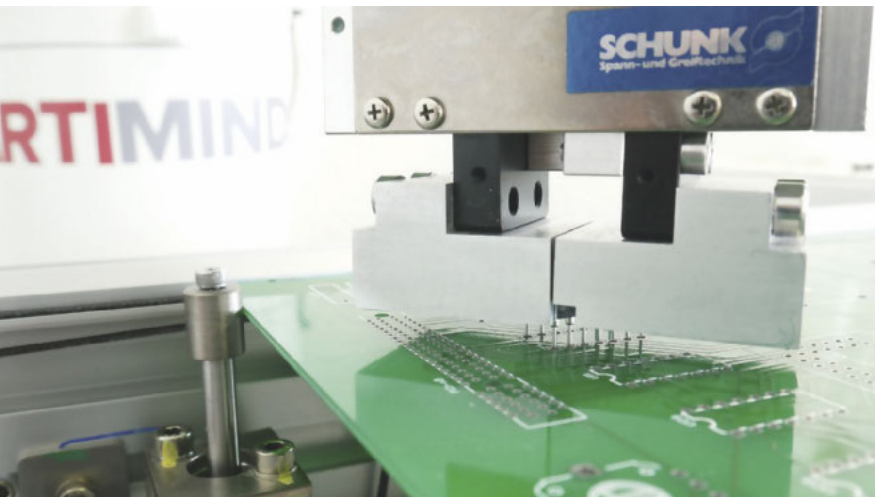
THT-Bestückung mit Schunk-Greifer: Roboter steckt Pins ein.
